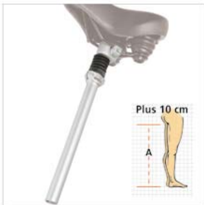
084 Federsattelstütze Diese Sattelstütze mindert entschei- dend die Belastung der Wirbelsäule. Beachten Sie die veränderte Sitzhöhe!
